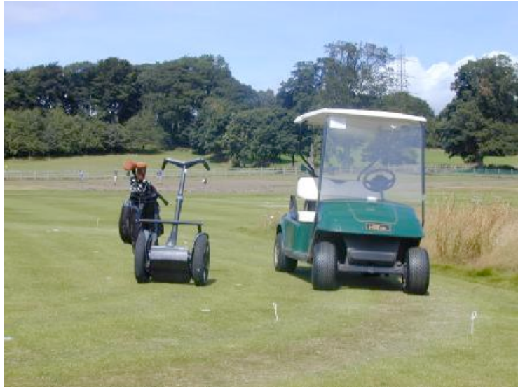
Traces après 280 passages. Chaque véhicule est sur sa voie de test
